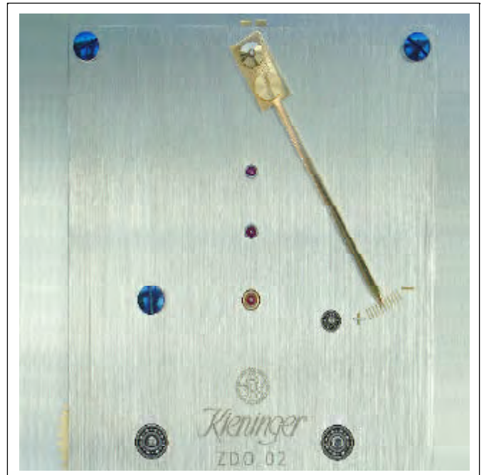
Bild 4 / Picture 4 Exzenterschraube & Justageanzeige Excenter screw & adjustment indicator
